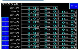
因为配合干燥工序，与调温步骤联动输入指示值。在跳过步骤操作的情况下，有时仓内真空度会突变。程序数最多为 10 个模式 12 个步骤。
