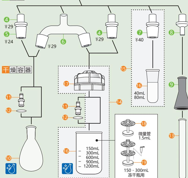
6多容器联用适配器中不可与10试料瓶用过滤器支架连接使用。
