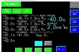
在干燥工序中输入任意的指示值，可以简单地进行真空控制。一步达到设置的真空度值，不能设置变化斜率。
