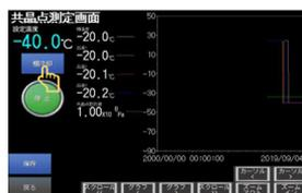
4. 点击【运行】后，【搁板冷却】按钮将呈蓝色亮起，可进行搁板冷却 ON/OFF。点击【搁板冷却】。
