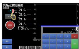
2. 设置搁板冷却到达温度。点击【设置温度】后，会显示数字键，输入要设置的温度。
