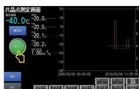
6. 【搁板冷却】图标变为蓝色，冷却停止，搁板温度向室温逐渐上升。停止运行时，点击【停止】。运行数据记录在主机上。
