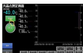
5. 【搁板冷却】图标从蓝色变为绿色，开始搁板冷却。继续冷却直至达到设定温度。达到设定温度后的搁板温度维持设定温度，直至再次点击【搁板冷却】。确认样品冻结后，点击【搁板冷却】。
